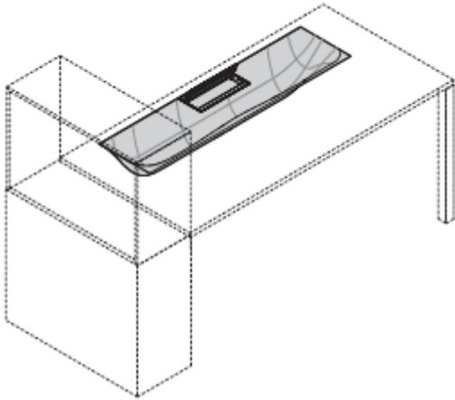
Top access cornice con vaschetta portacavi in termoformato per scrivania singola
