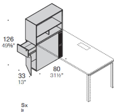
Base Joint per scrivania singola con cassetto e anta battente con vano libero
