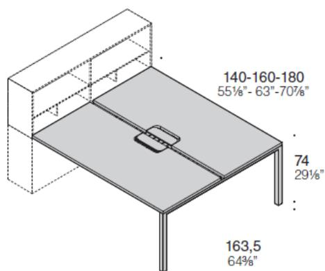
Bench 2 posti per base Joint con top access pivot e vaschetta portacavi
