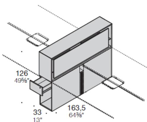
Base Joint intermedia per bench con cassetto e vano porta CPU o vano libero
