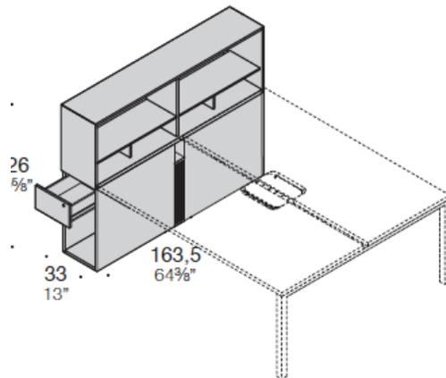
Base Joint per bench con cassetto e vano porta CPU o vano libero
