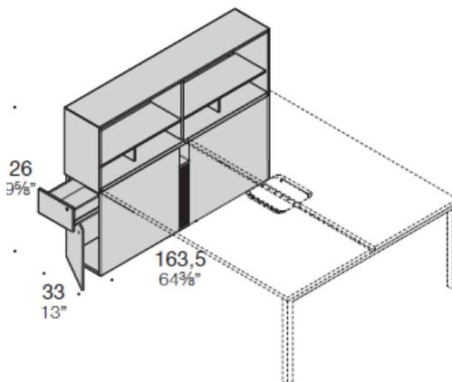
Base Joint per bench con cassetto e anta battente con vano libero
