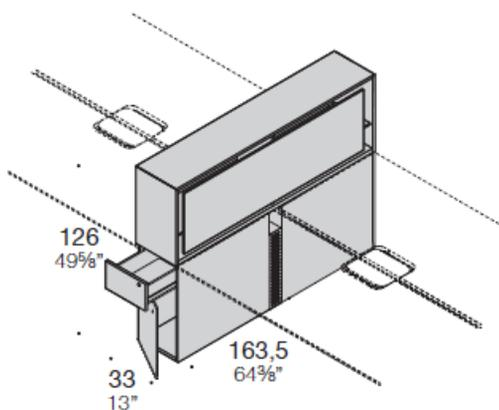
Base Joint intermedia per bench con cassetto e anta battente con vano libero
