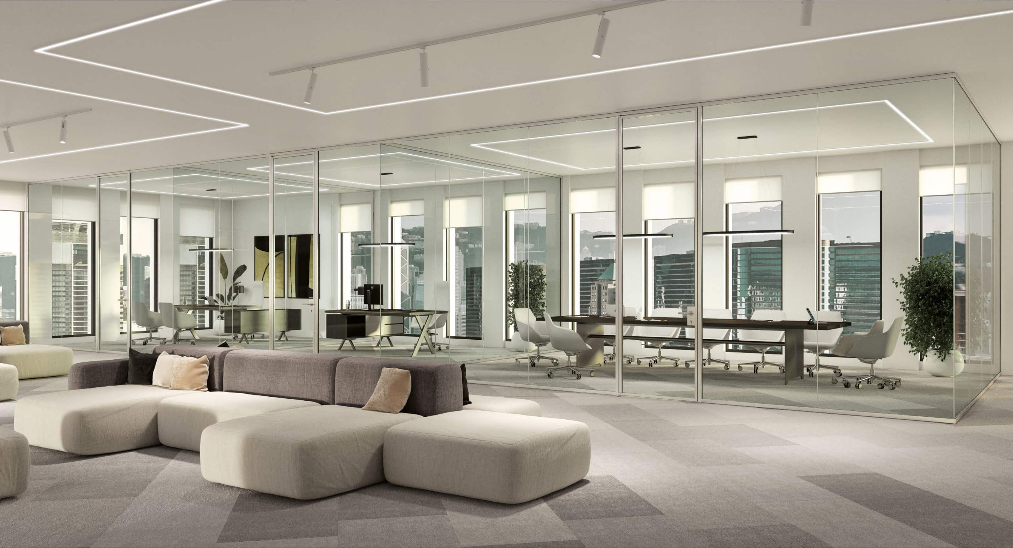
Parete 3 - 30 con tratte vetrate, porte battenti vetrate intelaiate, nodo a T vetrato, nodo a 90° Finitura: alluminio anodizzato.
