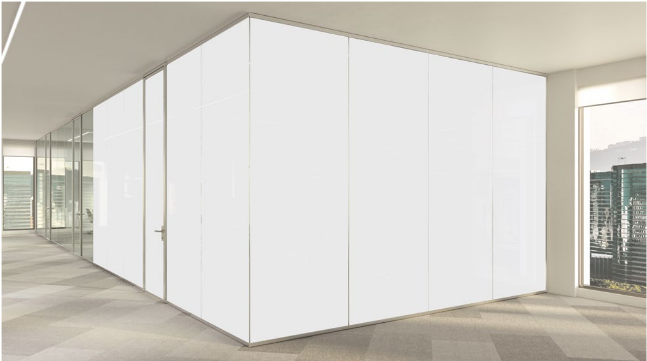
Esempio parete con vetro oscuramento totale attivo Example of partition with total shading glass active
