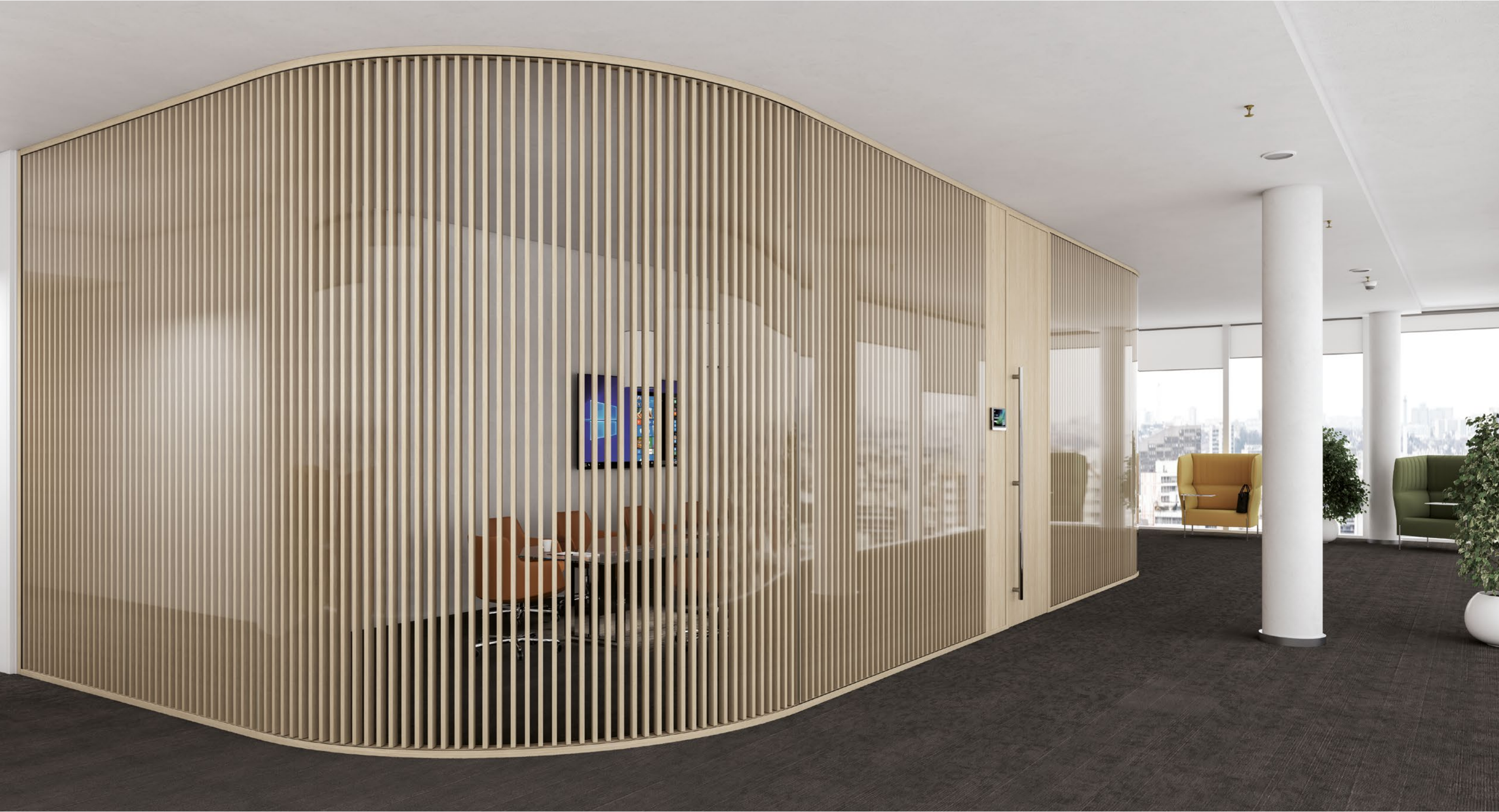
Parete 9 - 90 vetrata con masselli nell'intercapedine, profili impiallacciati e nodo curvo raggio 2 mt. Porta battente cieca tamburata con maniglione e modulo tecnico. Finitura rovere seppia.
